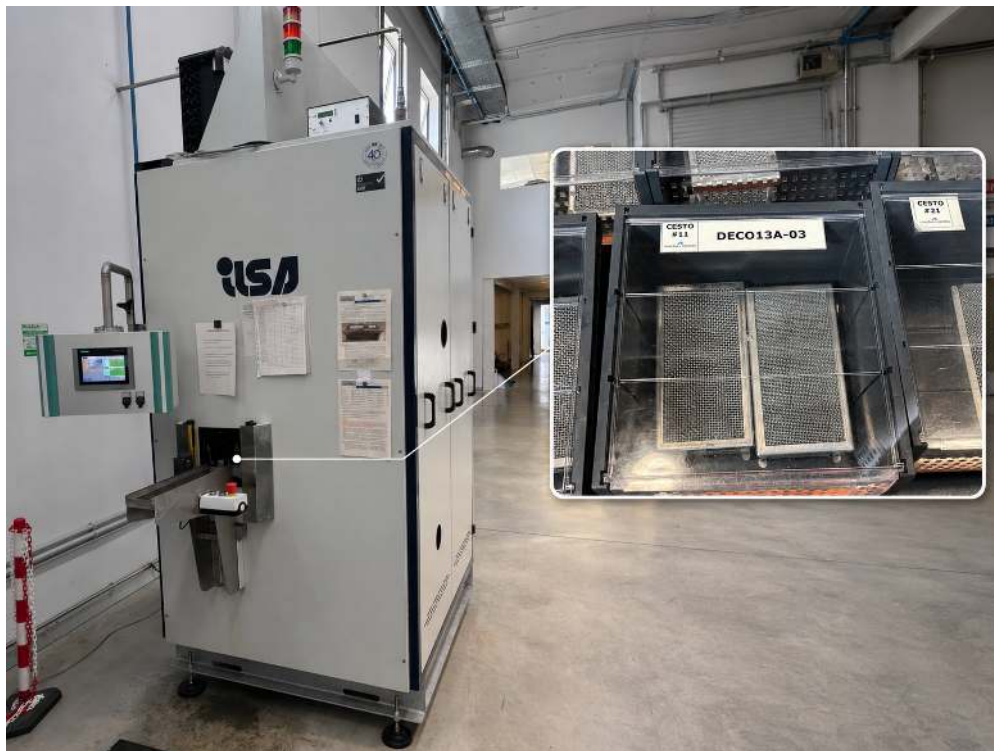
Figura II.8: Macchina per lavaggio dei semilavorati con gli appositi cesti di trasporto.
