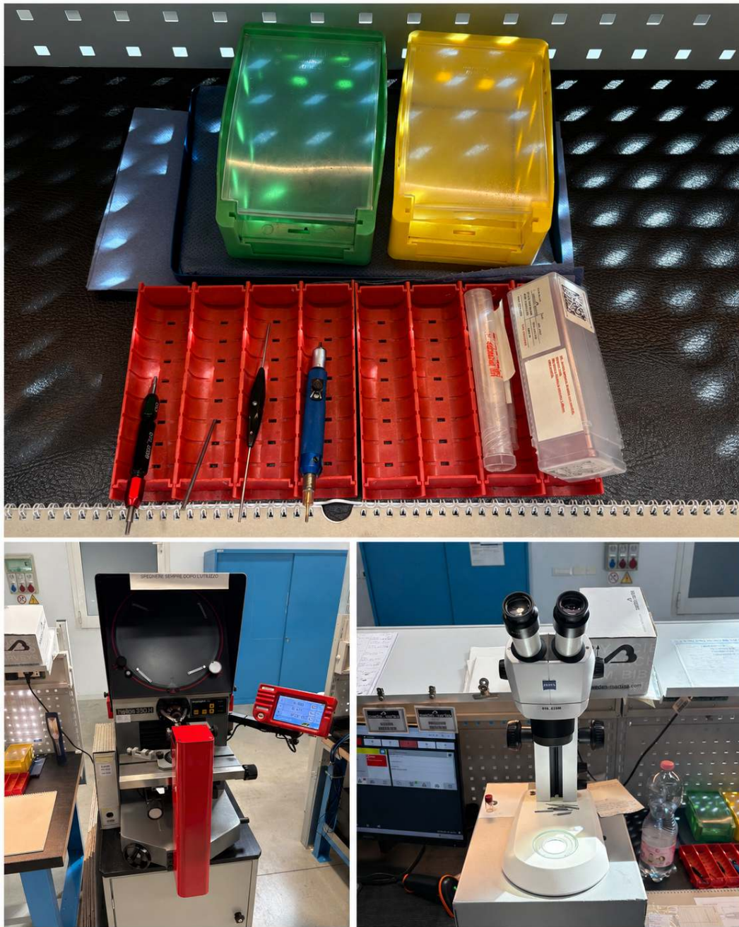
Figura II.6: Strumentazione utilizzata per le attività di controllo dimensionale e analisi visiva (proiettore di profili e microscopio).
