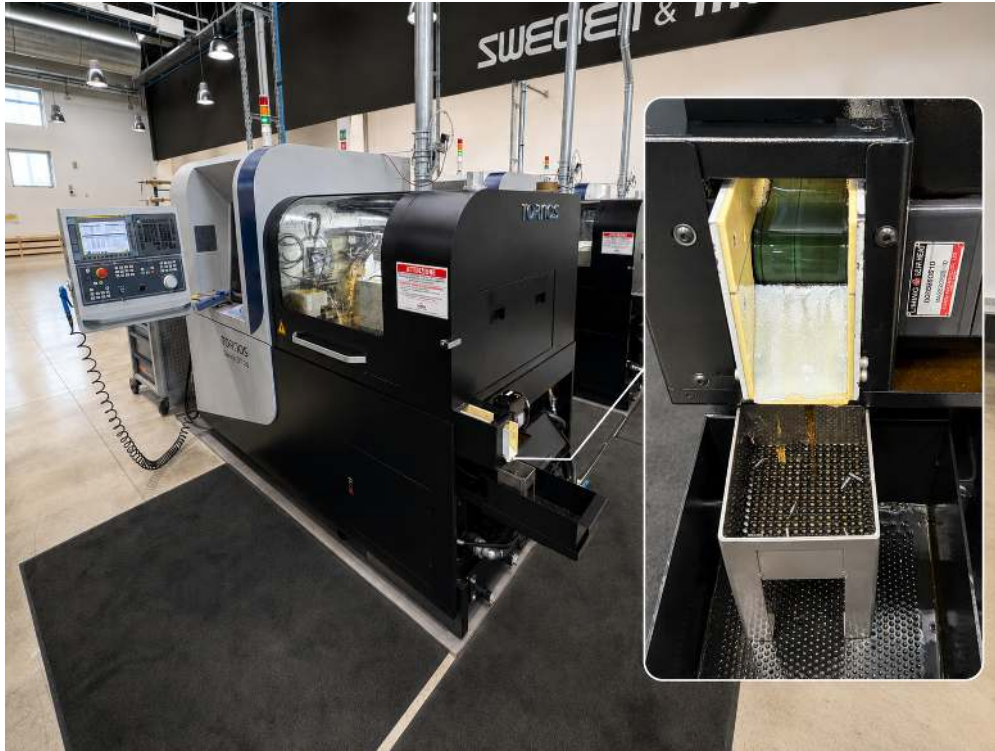
Figura II.7: Torno automatico Tornos Swiss GT 26 con dettaglio della bocca di scarico dei semilavorati.
