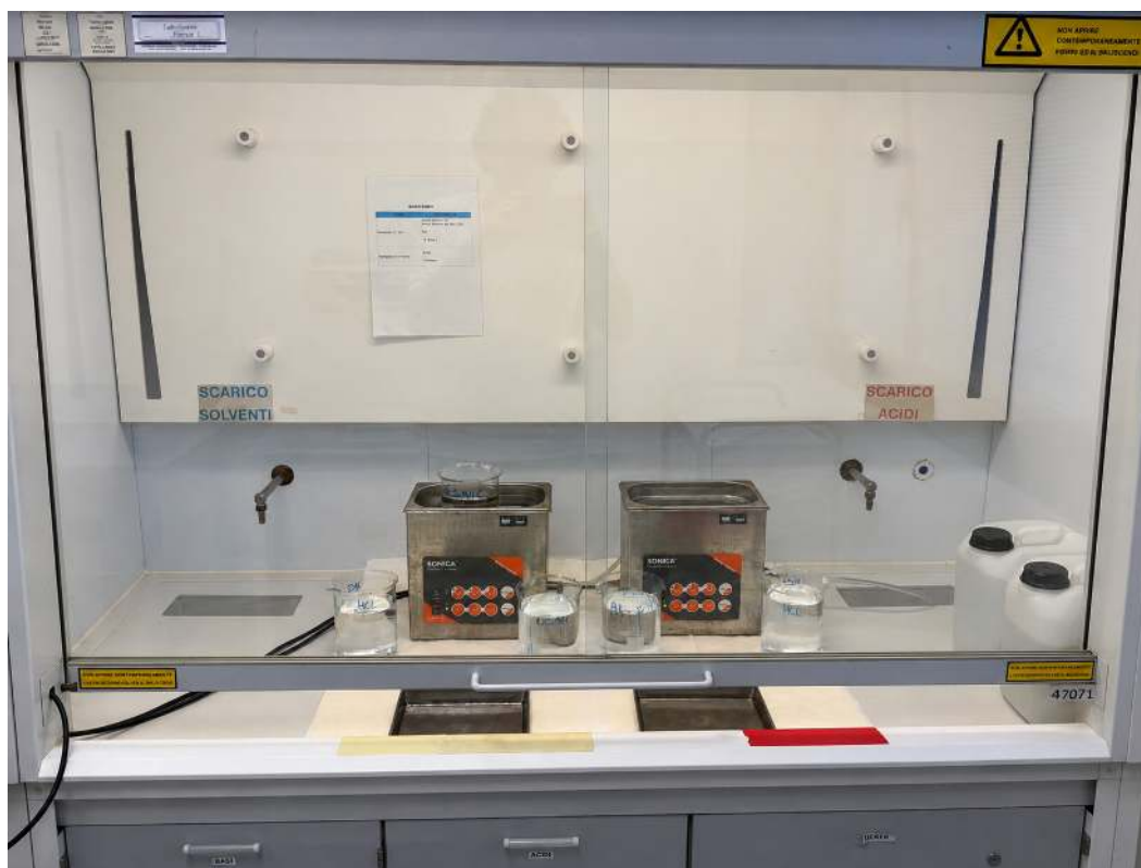
Figura II.13: Postazione per trattamento chimico sotto cappa aspirante.
